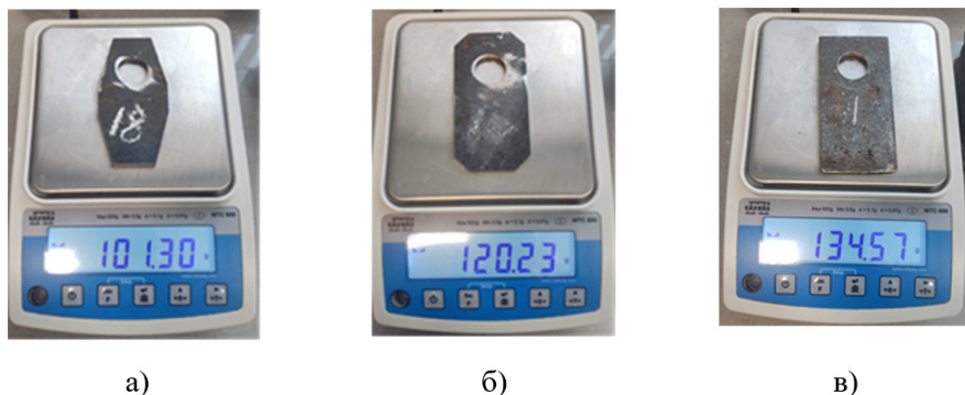
Рис. 2. Взвешивание молотков с одним шарнирным отверстием: а) угол наклона боковин 15^\circ ; б) угол наклона боковин 45^\circ ; в) серийный плоский прямоугольный молоток
